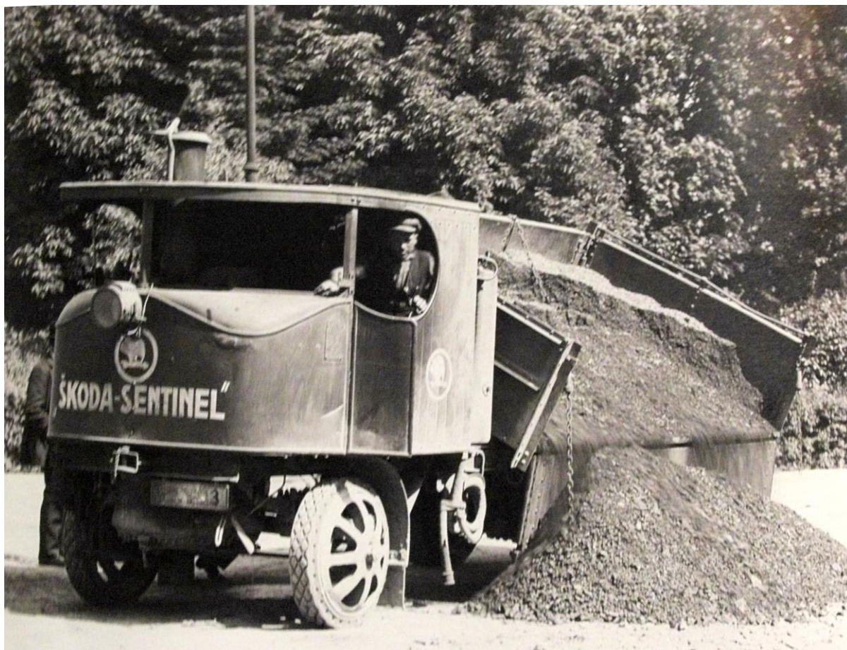
Prvý nákladný automobil Škoda Sentinel vyrobený pre štátne železiarne Podbrezová začiatkom 20. storočia ešte s parným strojom napriek sériovo vyrábaným úspornejším a výkonnejším benzínovým a naftovým spaľovacím motorom.
