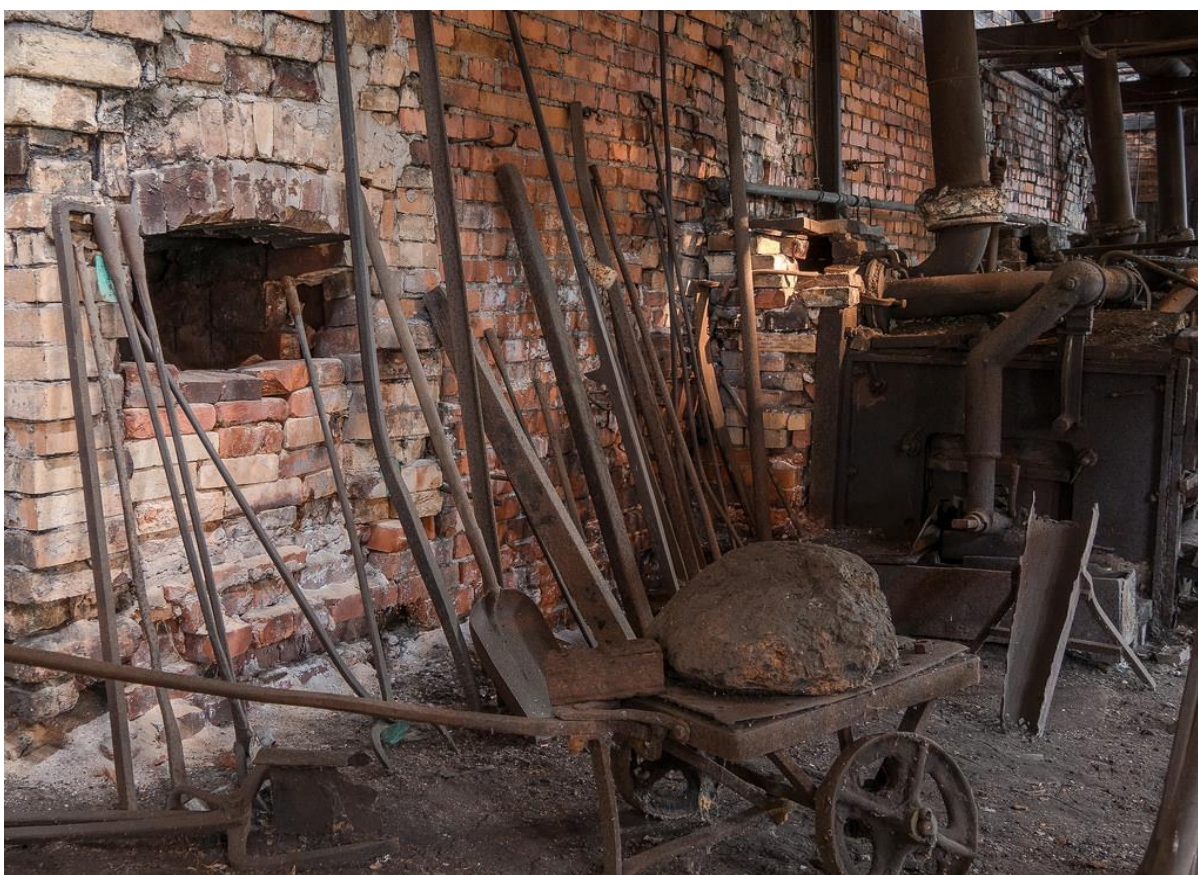
Bočný pohľad na rovnakú prevádzku skujňovacích vyhní. V popredí železný vozík na prepravu vytavenej hrudy kujného železa pred pudlovaním.
