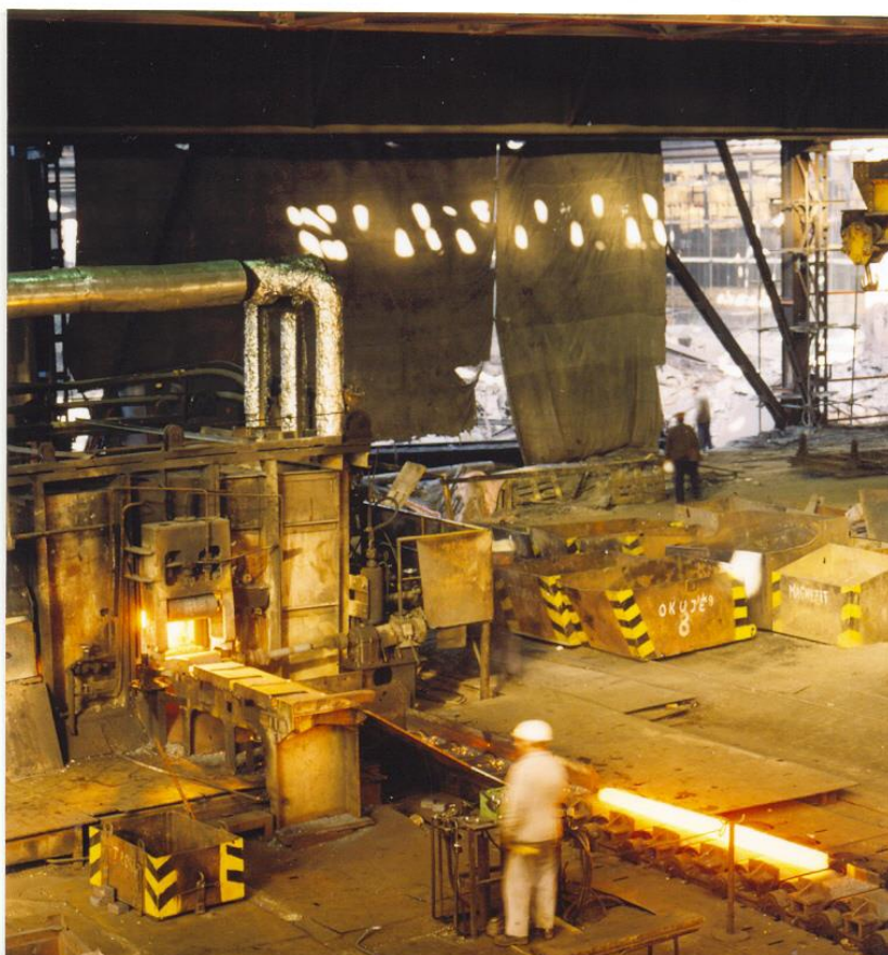
Vyťahovací vráток na výstupe narážacej ohrievacej pece podbrezovskej valcovne profilov.
