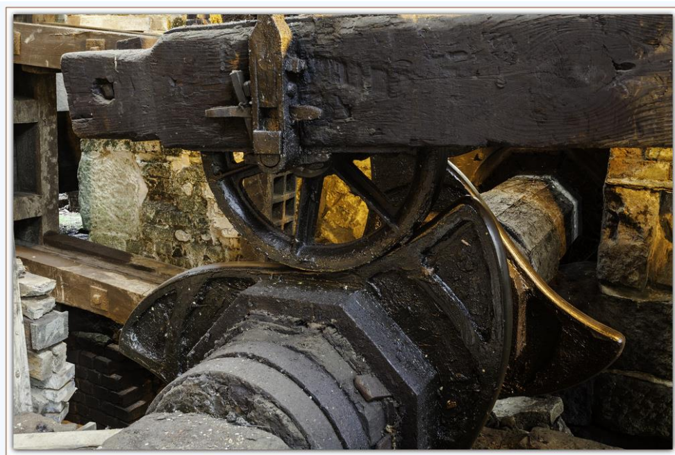
Mechanizmus vacky pákového mechanizmu skriňového dúchadla.
