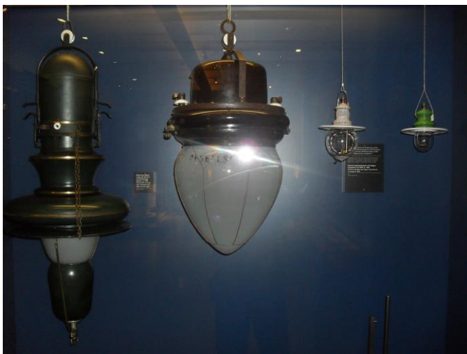
Osvetlenie v halách zabezpečovali oblúčkové lampy s vysokou svietivosťou spravidla vždy jedna uprostred objektu. V ostatných priestoroch sa používali Edisonove žiarovky.
