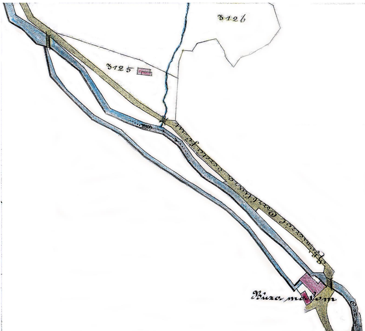
Plán komorského mlyna s vodným náhonom z r. 1882. Vľavo hore fabričný dom v dolinke Rudlová a hať na potoku Osrblianka. Drevená zástavba v súkromnom vlastníctve nie sú zakreslené.
