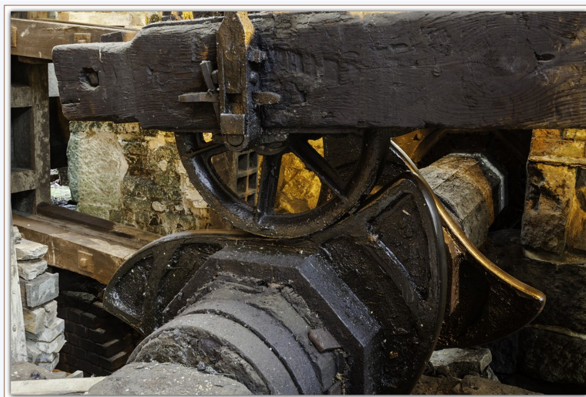
Novší vačkový systém ramena skriňových dúchadiel z konca 19. storočia.
