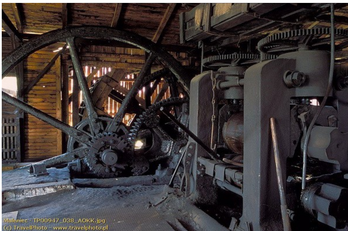
Pohľad na starú valcovňu s prevodom ozubeným súkolím so zotrvačníkom a v pozadí s vodným kolesom. Podobné inštalovali v Hroneckej valcovni (prvej v Uhorsku r.1814), v Piesku r. 1851, v Podbrezovskej pudlovni a valcovni v r. 1855 a vo Chvatimechu r. 1870.
