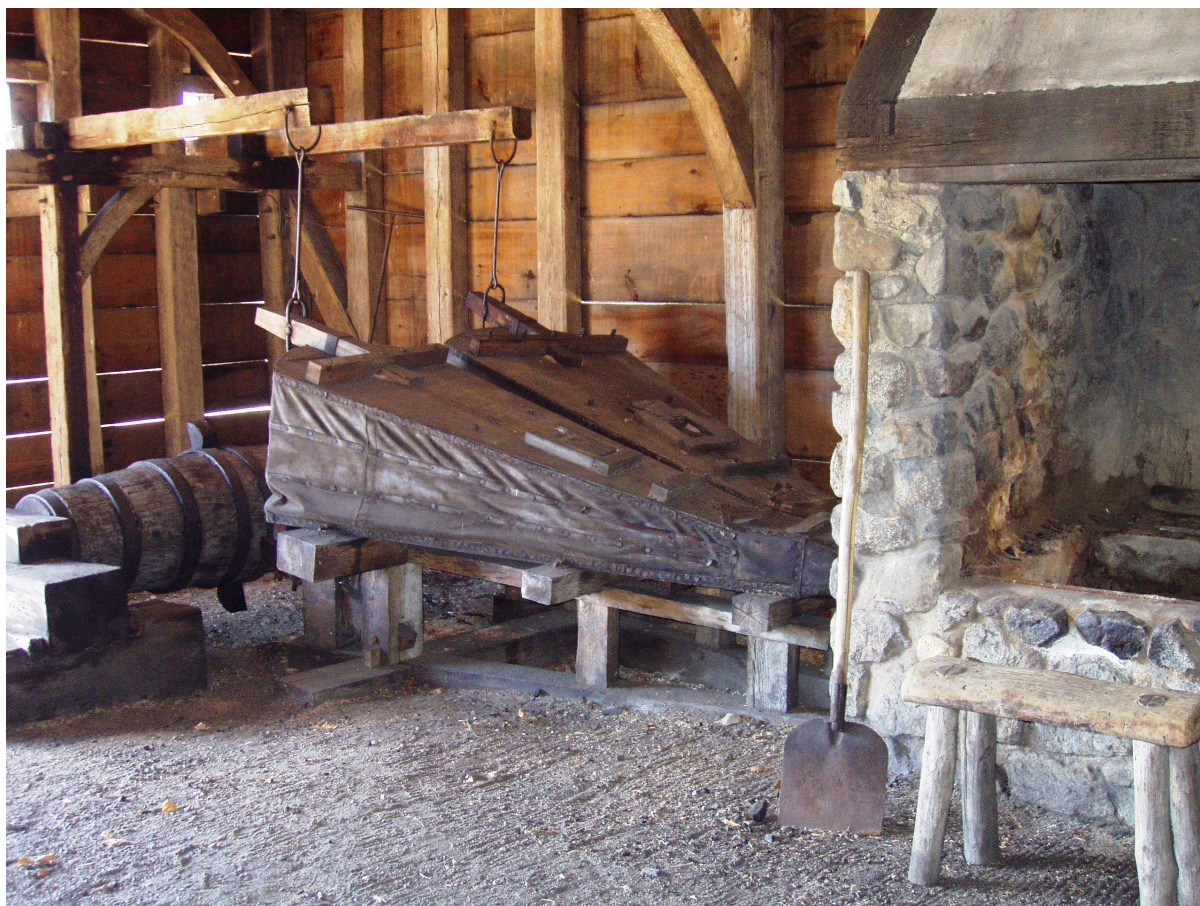
Vodný hriadel' s ložiskom a vačkami dvíhajúce tiahla kožených mechov kováčskej vyhne.
