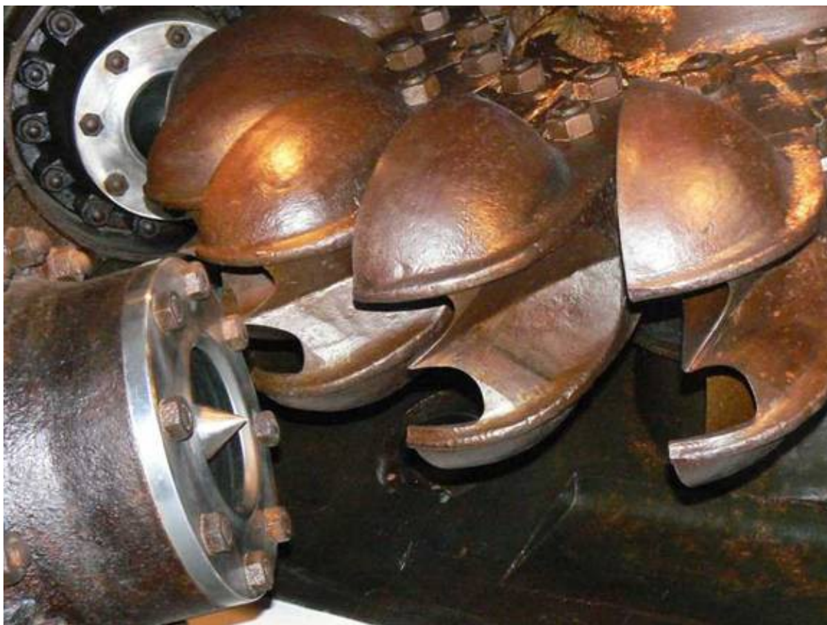
Detail lopatiek Peltonovej turbíny s dvojicou dýz. Z každej vyčnieva hrot regulačnej ihly. Miskovité lopatky obežného kola rozdeľujúce vodný prúd na dva ktorý po odovzdaní kinetickej energie opúšťa v oblúku lopatku pod uhlom obchádzajúcim nasledovnú lopatku.
