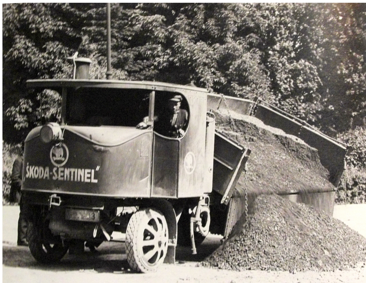
Nákladné vozidlo Škoda-Sentinel na parný pohon vyrobený v r. 1912 s výkonom 70 HP (koská sila) pri 3 000 ot./min. a spotrebe 3,5 kg uhlia a 10 litrov vody na kilometer. Aj železiareň pod Brezovou vlastnila takýto stroj. Ten začal nahrádzať fabrické konské povozy.
