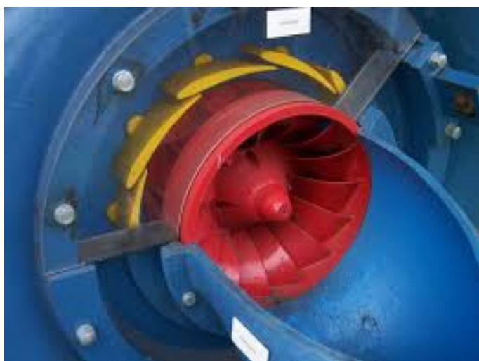
Francisova kolenová turbína (červená) v šachte s ovládanými navádzacími lopatkami (žlté).
