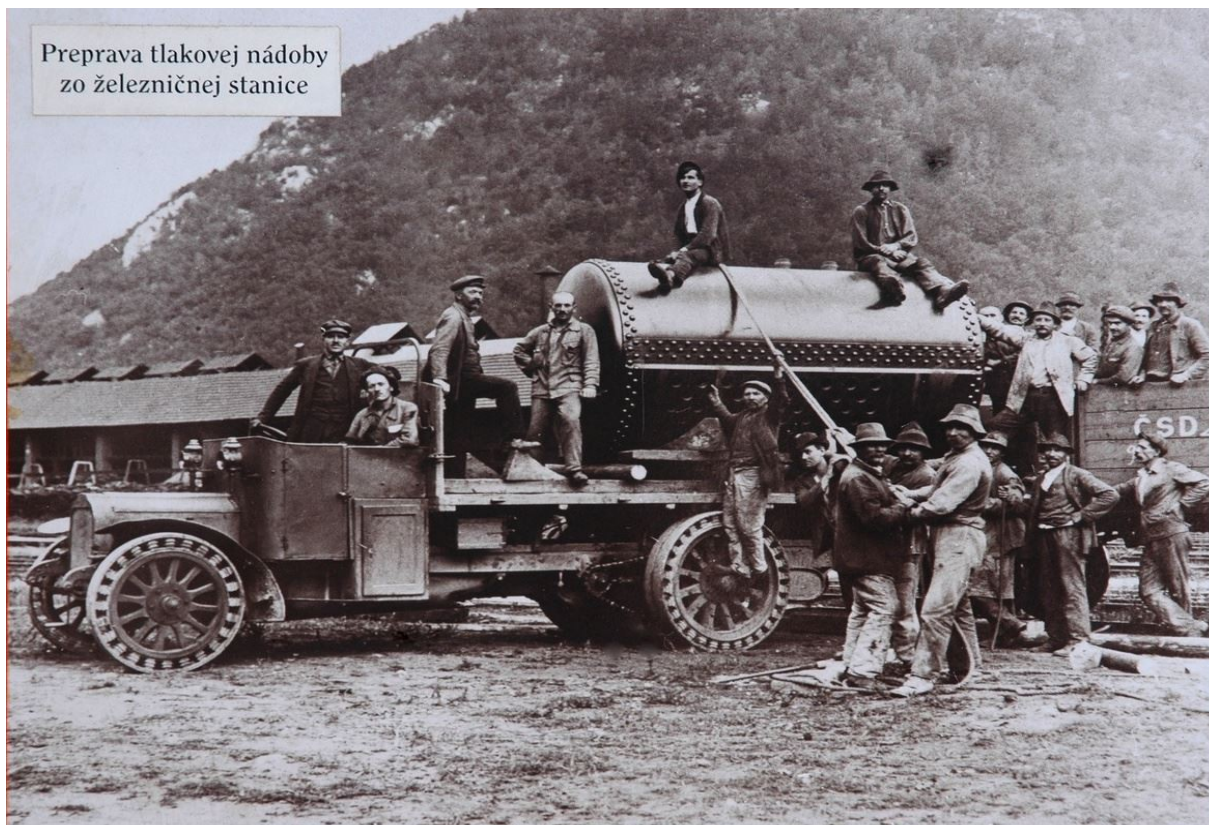
Nákladný automobil v Tisovci so spaľovacím motorom a bezdušovými pneumatikami.
