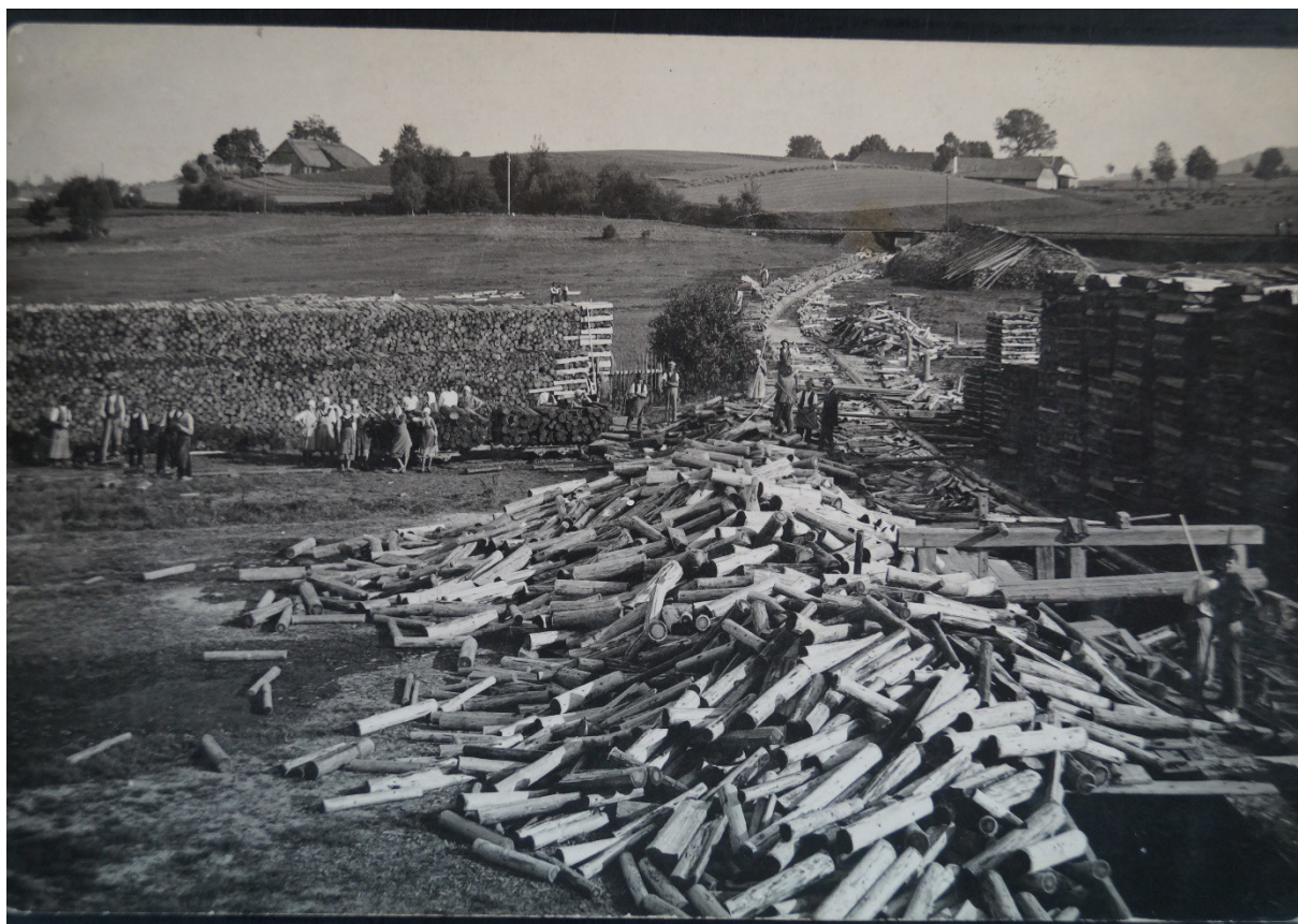
Vytiahnuté krátke drevo z plavebného kanála sa ukladá do šichtúňov aby sa zmeralo a vysušilo.
