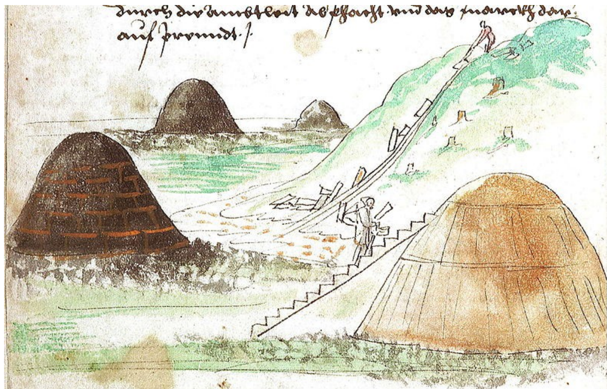
Dobová kresba uhliarskej dielne s vyznačenou rizňou na približovanie krátkeho dreva zo svahov vzdialených rúbanísk k uhliisku. V popredí ukladanie dreva do miliera.
