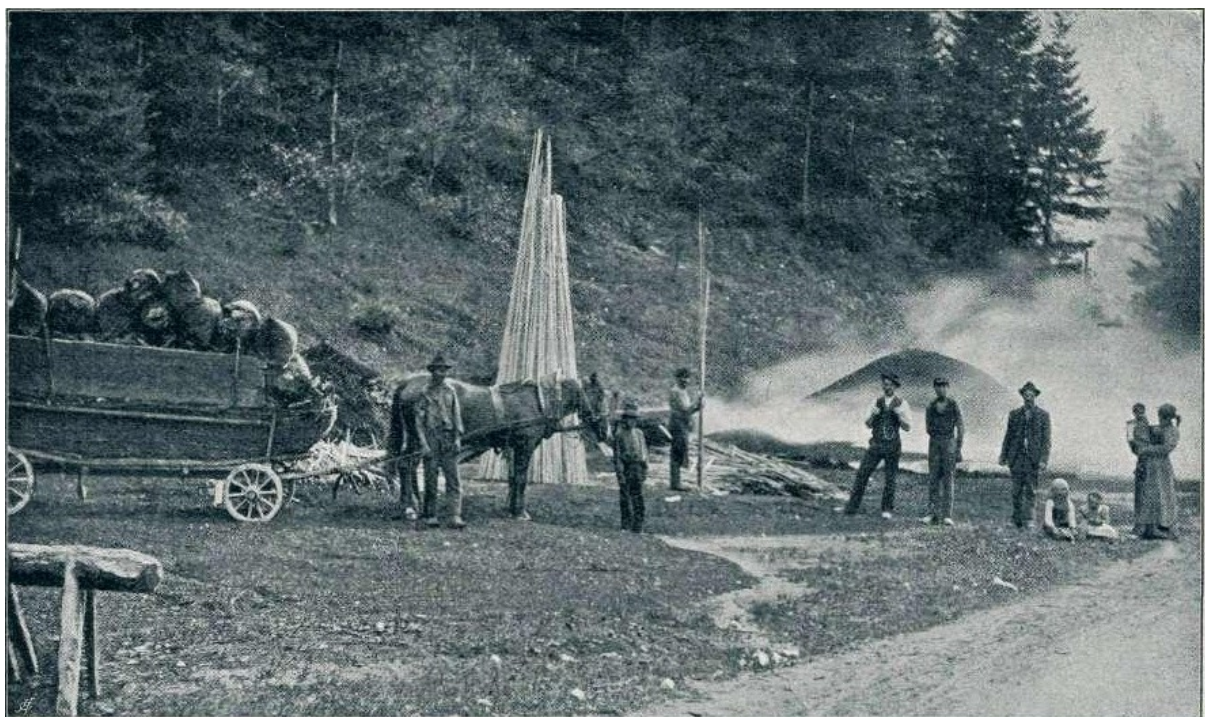
Odvoz hotového drevného uhlia baleného do vriec v upravenom sennom voze.
