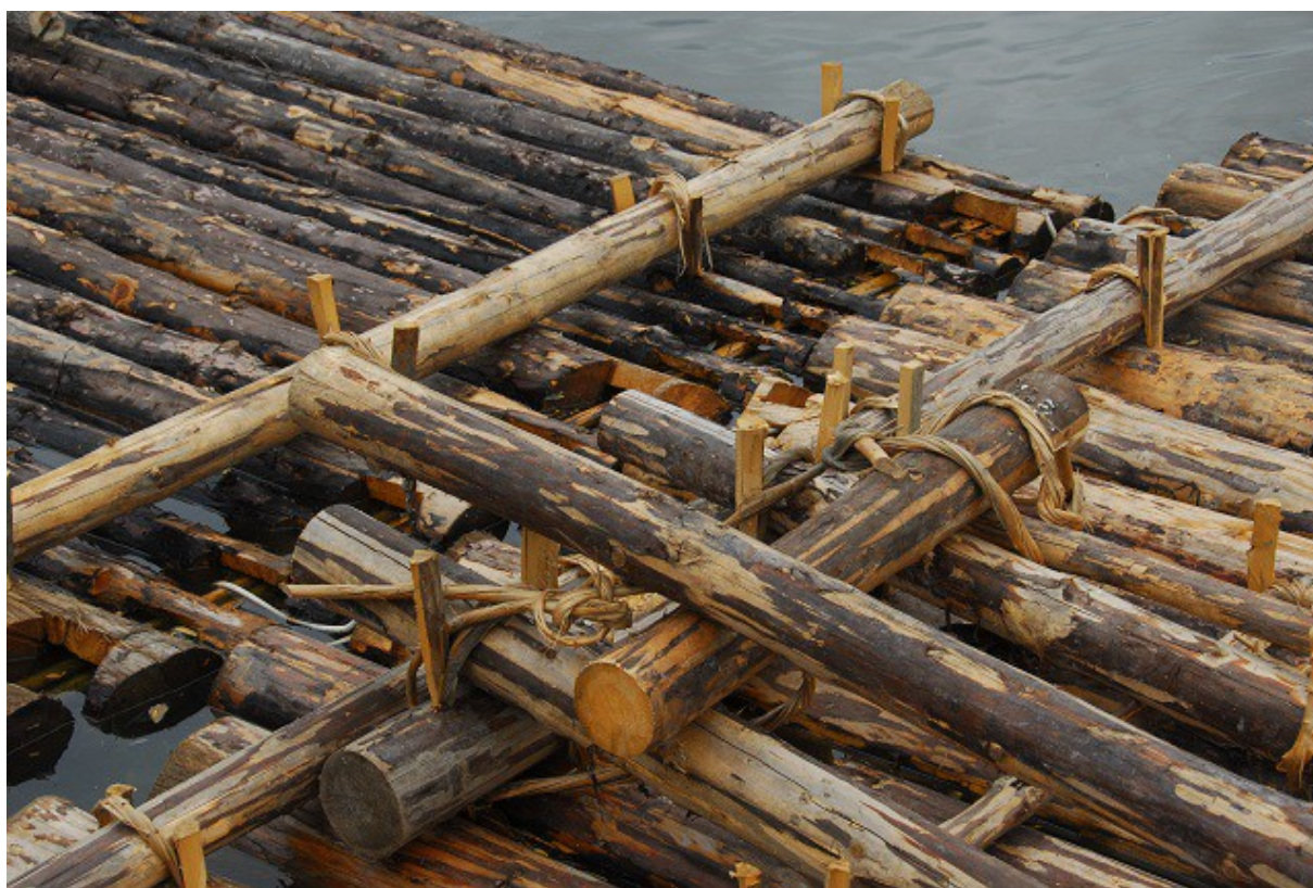
Konštrukcia plte spájanej drevenými kolíkmi a prútenými lanami .
