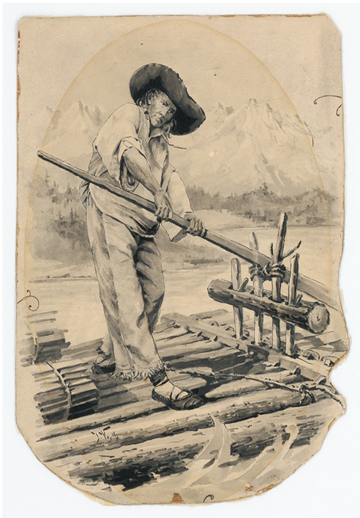
Pltník obsluhujúci zviazané dlhé drevo do plte kormidlom vpredu aj vzadu. Vtavo je prepravovaný náklad drevených šindľov v zväzkoch po dvadsať.
