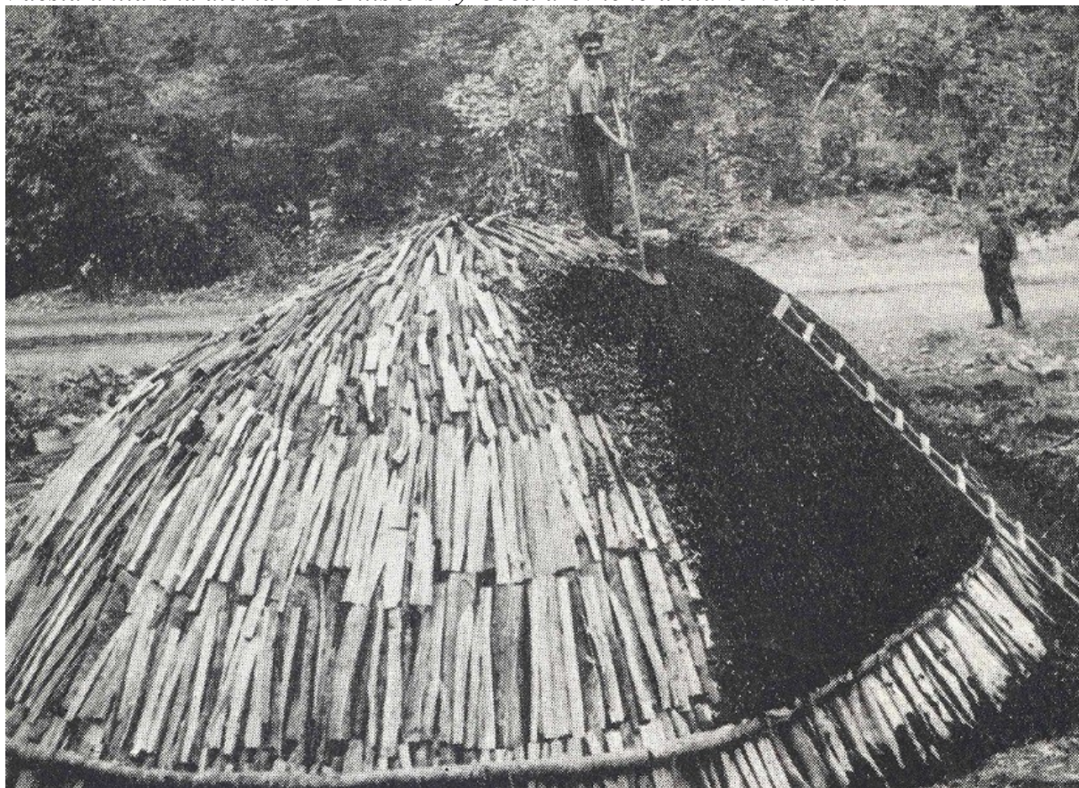
Zakrývanie miliera zeminou pred jeho zapálením.
