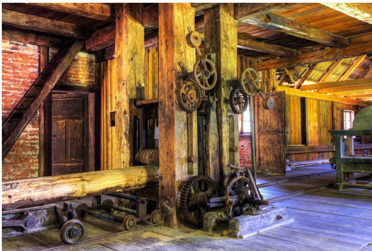
Drevený gátor staršej konštrukcie bez pojazdného stola, teraz z dopravníkom na koľajniciach.
