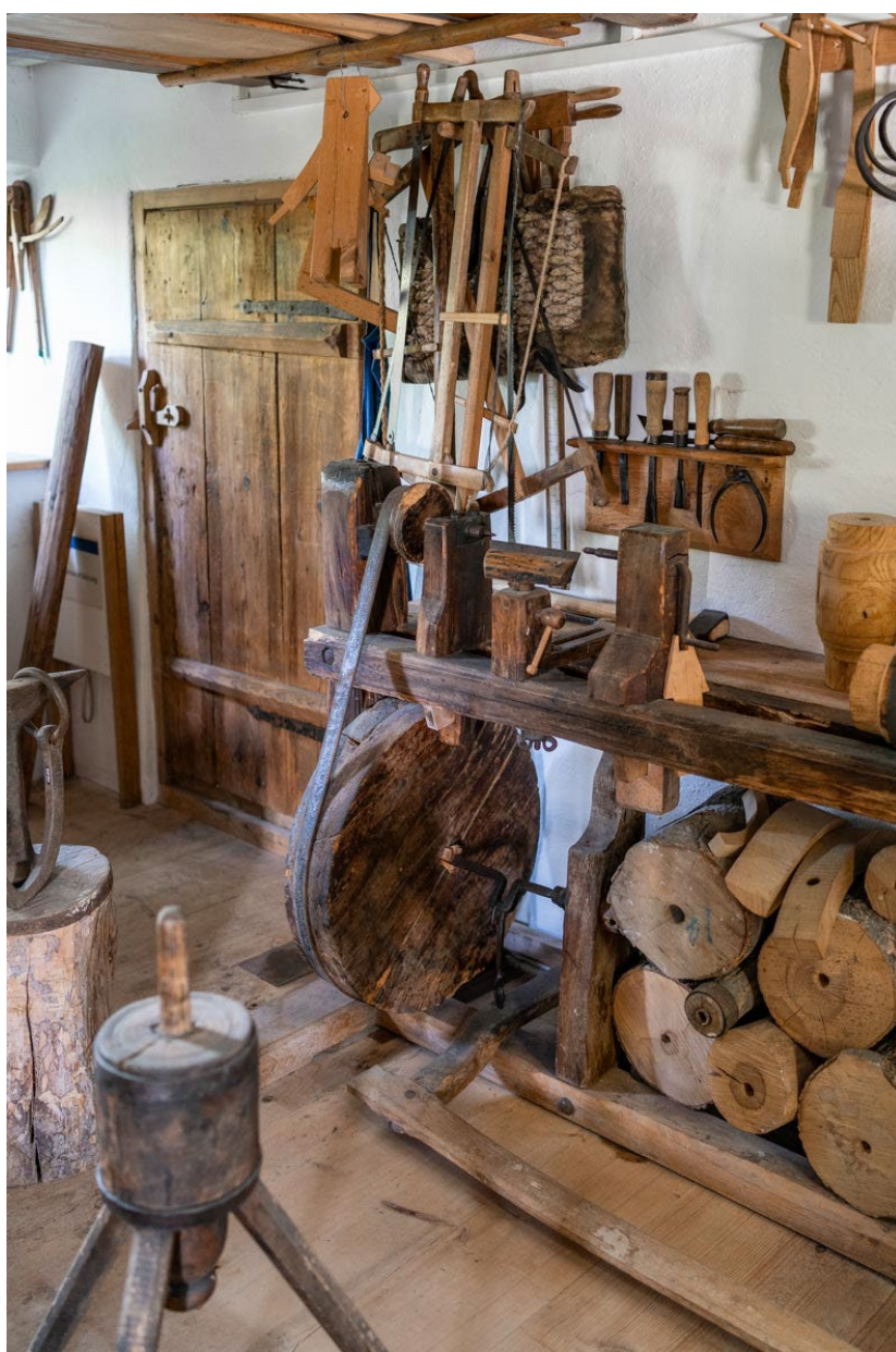
Tokárska dielňa dole s pripraveným polotovarom predvrtaných klátikov.
