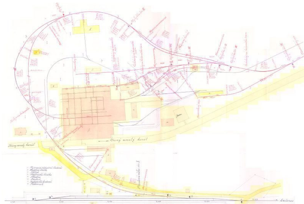
na obrázku: plán železiarne UNION vo Zvolene z prelomu 19. a 20. storočia. Nachádzal sa pri sútoku Hrona a Slatiny. Celkom dole železničná stanica Zvlen. Uprostred vodný náhon Hrona na pohon valcovne ,v súčasnosti MVE Zvolen. Plán obsahuje rozsiahlu železničnú sieť.
