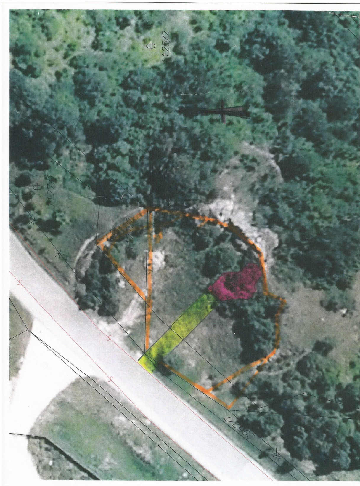
Ortofotomapa so zakresleným prvým návrhom Hutníckeho skanzenu na Skalke. Žto je vyznačená prístupová komunikácia v areáli skanzenu, červene murovaný hlavný objekt s rozhľadňou a technickým zázemím, orandžovo je vyznačené oplotenie areálu Skalky určeného pre voľné umiestnenie exponátov. Celkom vľavo dole cesta III. triedy Chvatimech – Valaská s odbočkou do Valaskej – Piesku.
