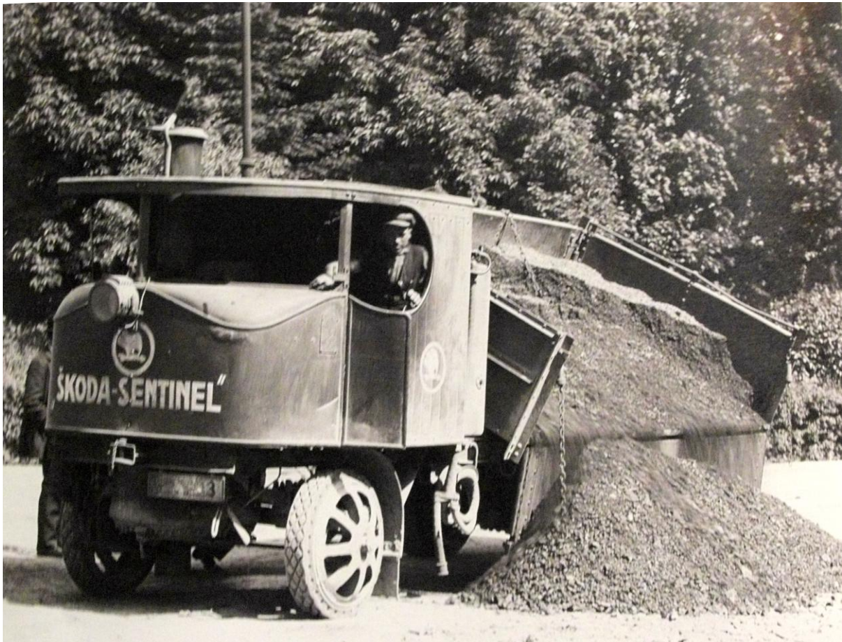
Obr. 123. Prvý nákladný automobil Škoda Sentinel vyrobený pre štátne železiarne Podbrezová začiatkom 20. storočia ešte s parným strojom napriek sériovo vyrábaným úspornejším a výkonnejším benzínovým a naftovým spaľovacím motorom.
