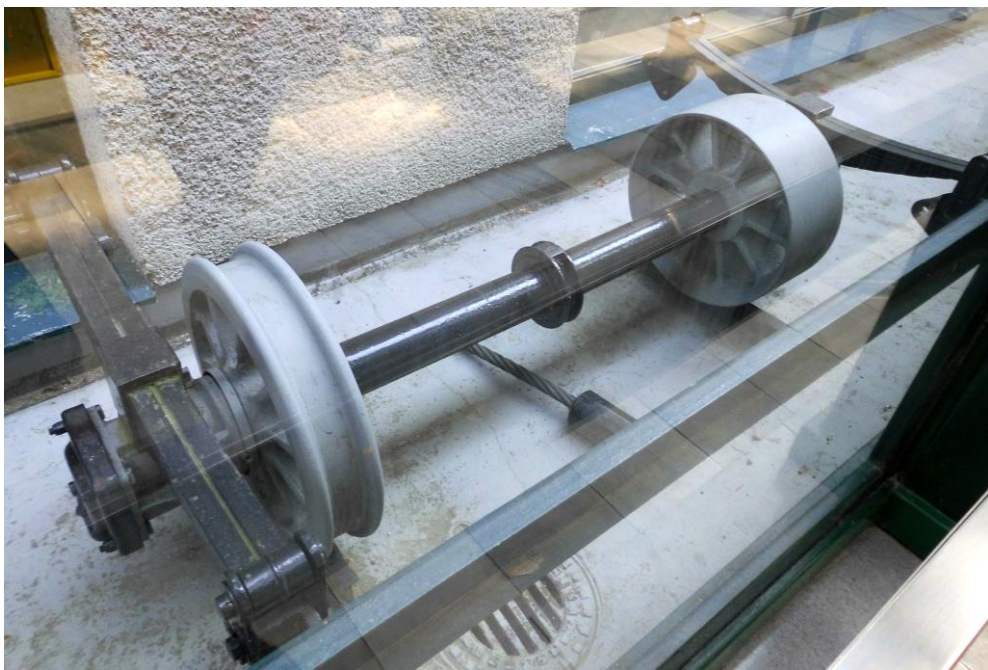
Obr. 112. Ilustračné foto na súkolie vozíka pozemnej lanovky s vodiacim kolesom s okolesníkom po oboch stranách pre vonkajšiu koľaj výhybne a vnútorné koleso bez okolesníka na prechod z jednej koľaje na druhú bez potreby pohyblivej časti výmeny.
