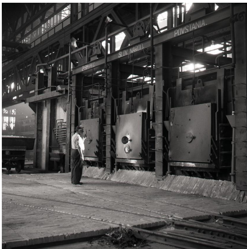
Obr. 97. Trojica vsádzacích otvorov 35 T SM pece v Podbrezovej.
