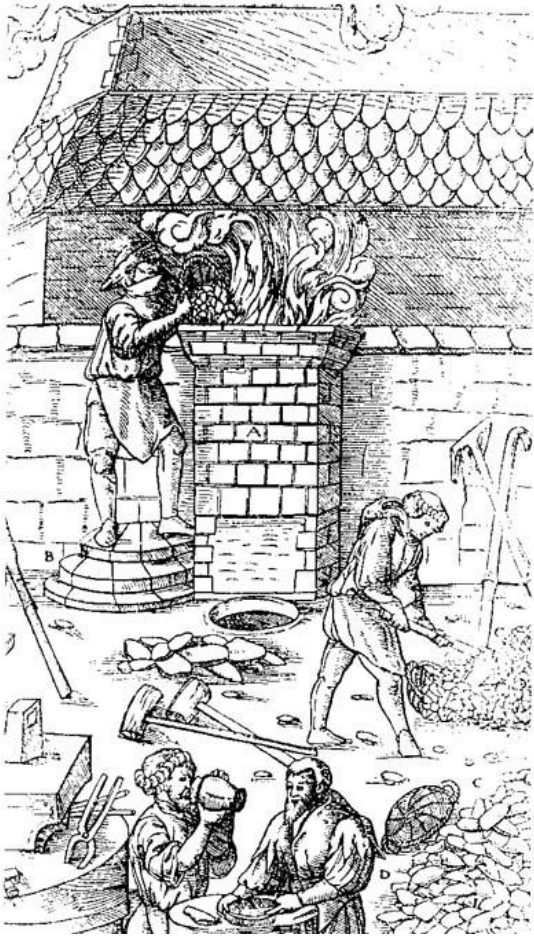
Obr. 9. V stredoveku sa ťachtová pec presúva nad zem podľa obrazu Agricoli.
