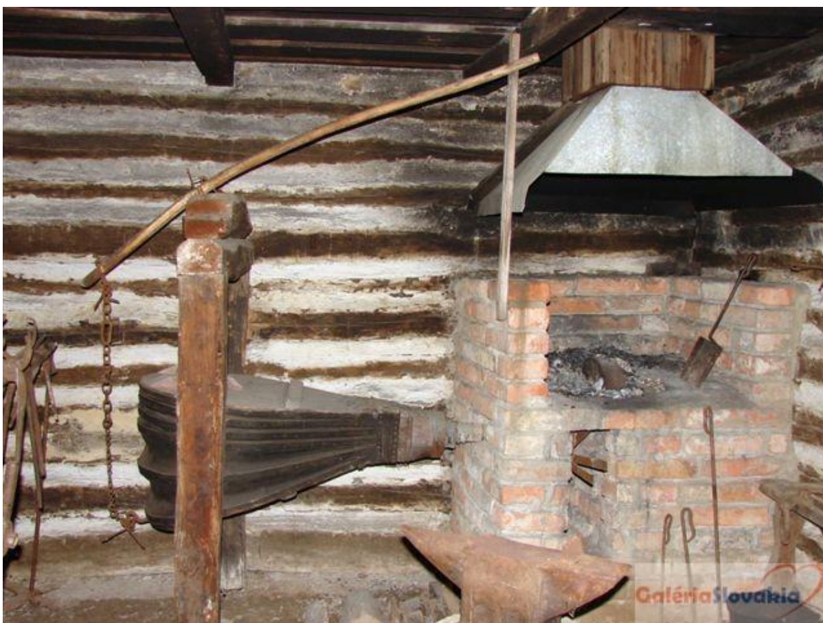
Obr. 5. Klasická kováčska vyhňa s dýchacím koženým mechom prežila do dnešných čias.
