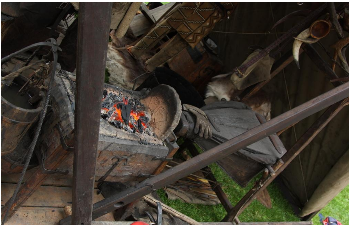
Obr. 6. Prenosná vyhňa je zo súčasnosti, ale podobné prenosné kováčske dielne putovali s každým vojskom od nepamäti aby opravovali a prekúvali zbroj vojska.
