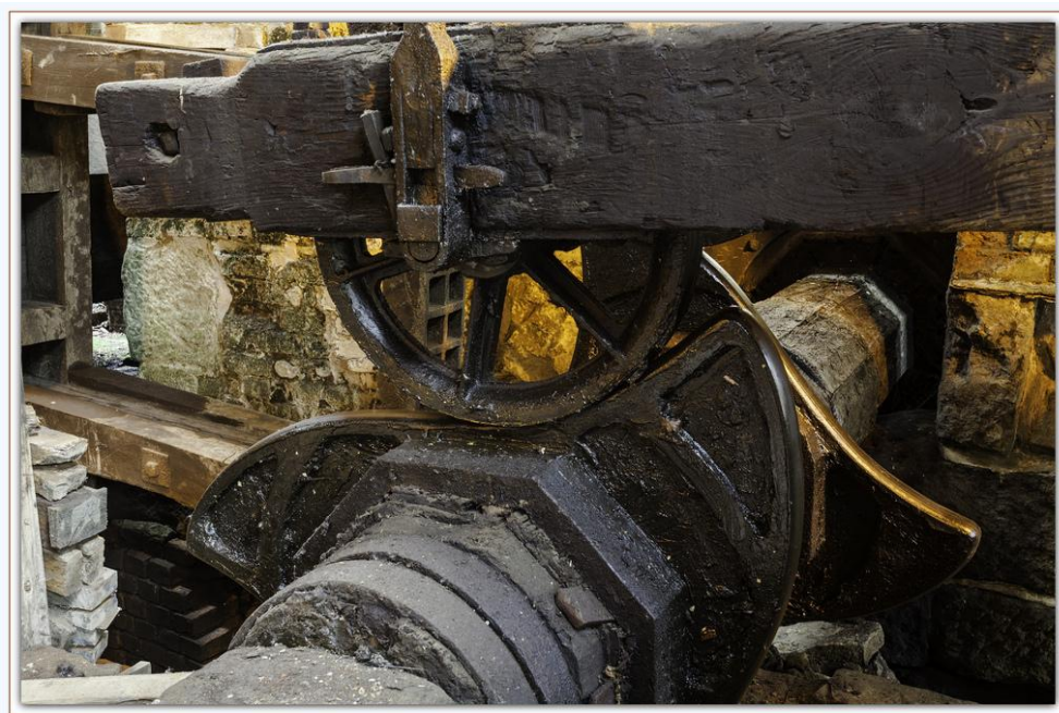
Obr. 13. Mechanizmus vačky pákového mechanizmu skriňového dúchadla.
