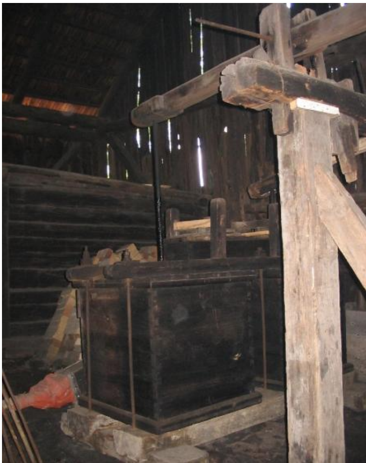
Obr. 11. Foto skriňového duchadla s pákovým ramenom hore prepojených s piestom železnou tyčou. Neskôr bol zmodernizovaný z jednočinného na dvojčinný.
