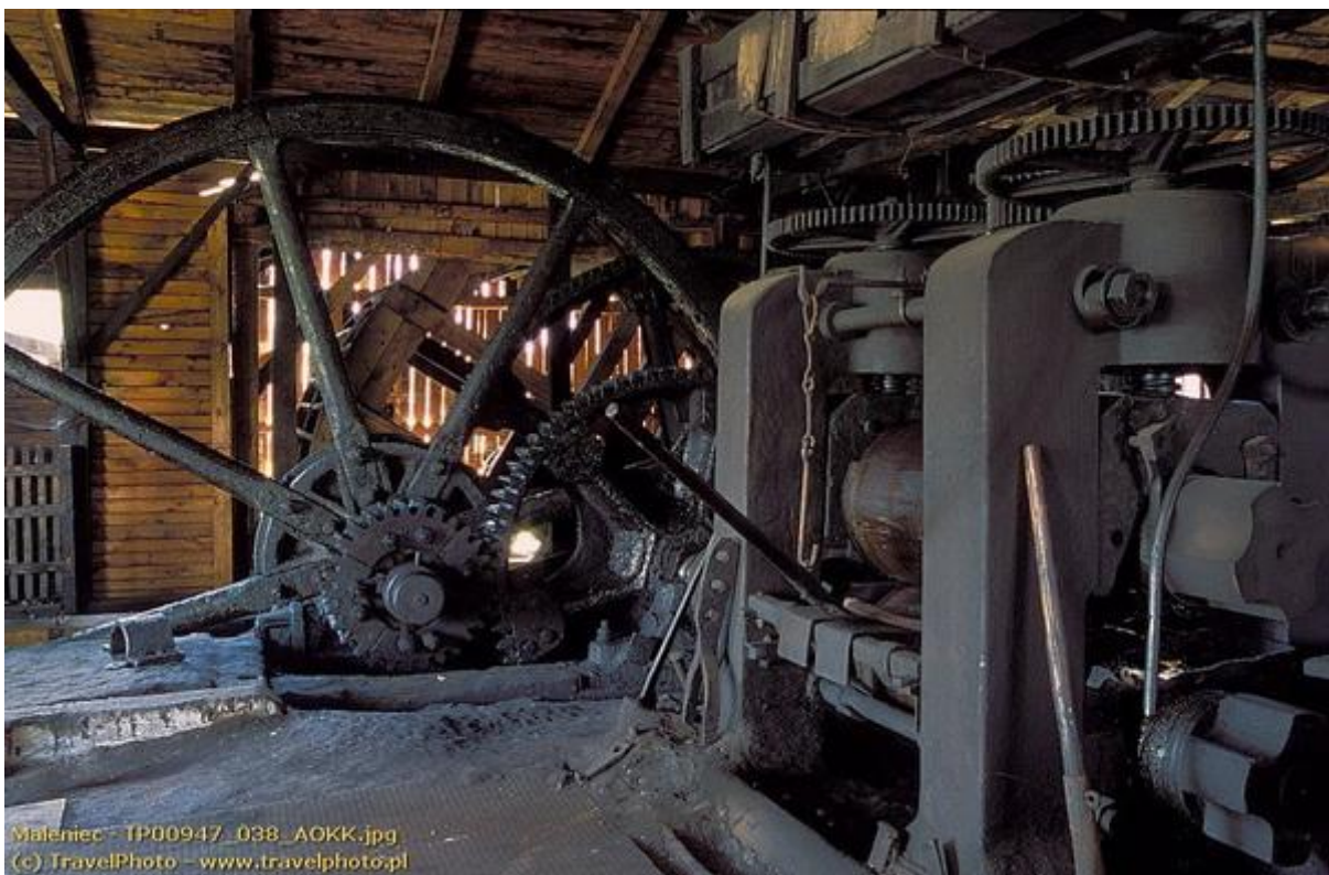
Obr. 73. Pohľad na starú valcovňu s prevodom ozubeným súkolím so zotrvačníkom a v pozadí s vodným kolesom. Podobné inštalovali v Hroneckej valcovni (prvej v Uhorsku r.1814), v Piesku r. 1851, v Podbrezovskej pudlovni a valcovni v r. 1855 a vo Chvatimechu r. 1870.
