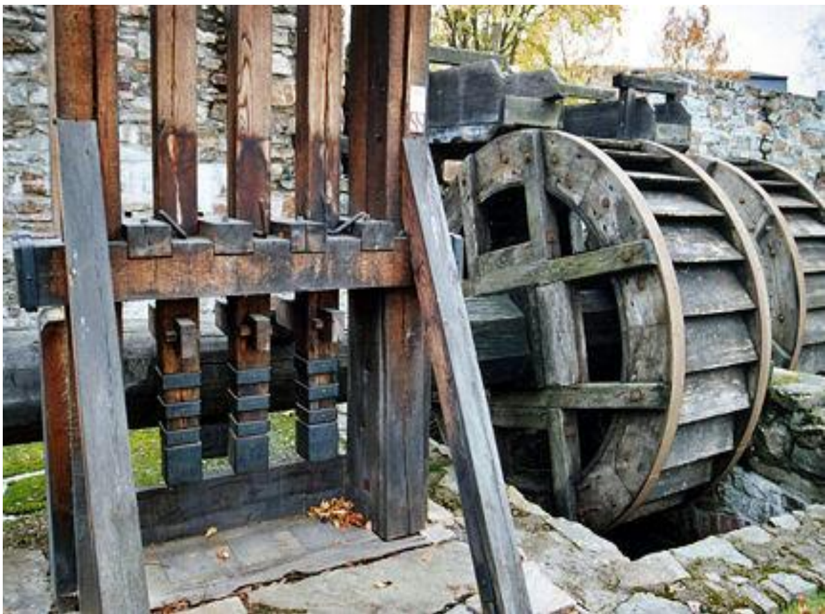
Obr. 10. Vačkový systém pohonu drevených (dolu okovaných) tĺkov stúp z hriadeľa vodného kolesa.
