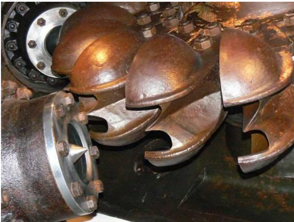
Obr. 16. Detail lopatiek Peltonovej turbíny s dvojicou dýz. Z každej vyčnieva hrot regulačnej ihly. Miskovité lopatky obežného kolesa rozdeľujúce vodný prúd na dva ktorý po odovzdaní kinetickej energie opúšťa v oblúku lopatku pod uhlom obchádzajúcim nasledovnú lopatku.
