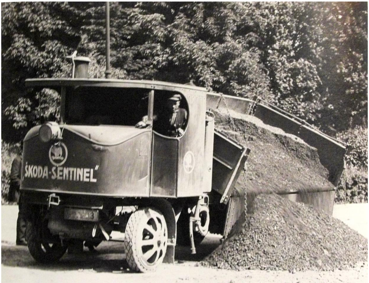
Obr. 36. Nákladné vozidlo Škoda-Sentinel na parný pohon vyrobený v r. 1912 s výkonom 70 HP (koňská sila) pri 3 000 ot./min. a spotrebe 3,5 kg uhlia a 10 litrov vody na kilometer. Aj železiareň pod Brezovou vlastnila takýto stroj. Ten začal nahrádzať fabrické koňské povozy.
