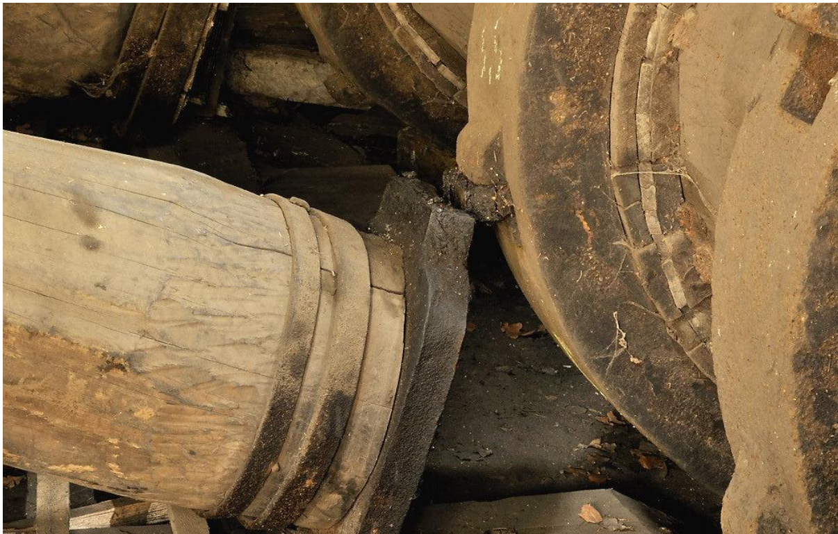
Obr. 8. Detail okovania hriadel'a vodného kolesa a ramena kladiva bucharu.
