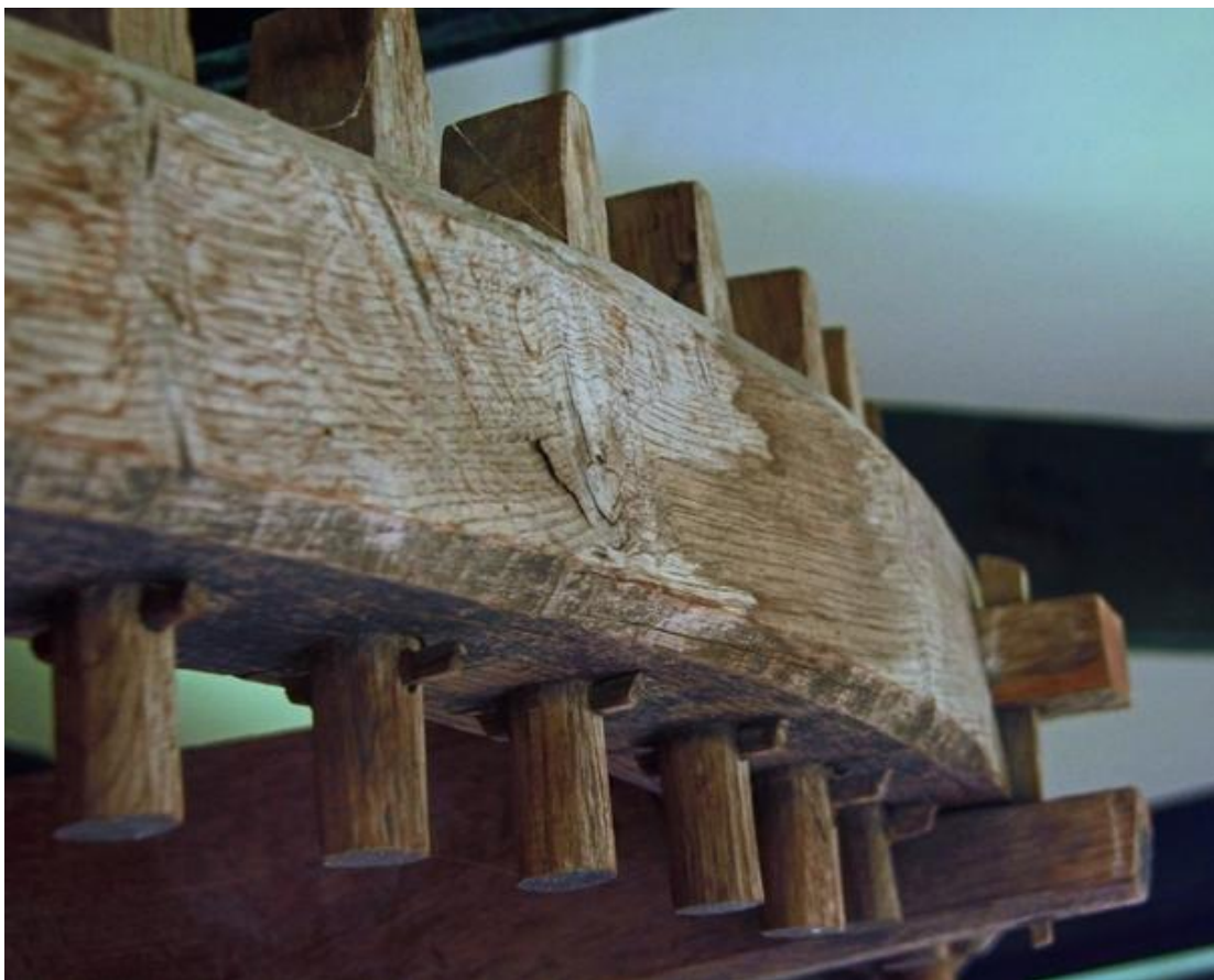
Obr. 11. Detail palečného prevodového kolesa. Jeho výroba bola zdĺhavá a preto drahá.
