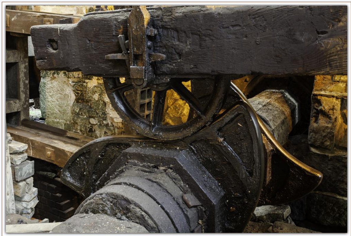
Obr. 9. Novší vačkový systém ramena skriňových dúchadiel z konca 19. storočia.
