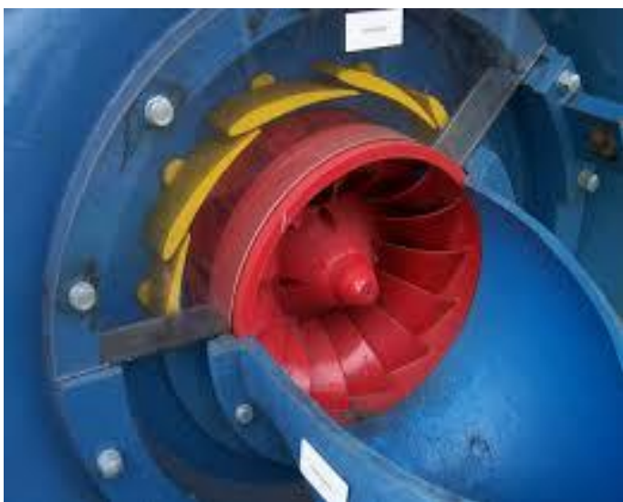
Obr. 19. Francisova kolenová turbína (červená) v šachte s ovládanými navádzacími lopatkami (žlté).
