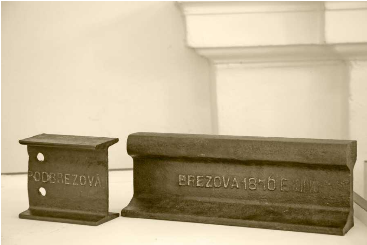
Obr. 114. Ukážka valcovaného tovaru ako profilová oceľ „I“, a koľajnica s rokom výroby 1870.
