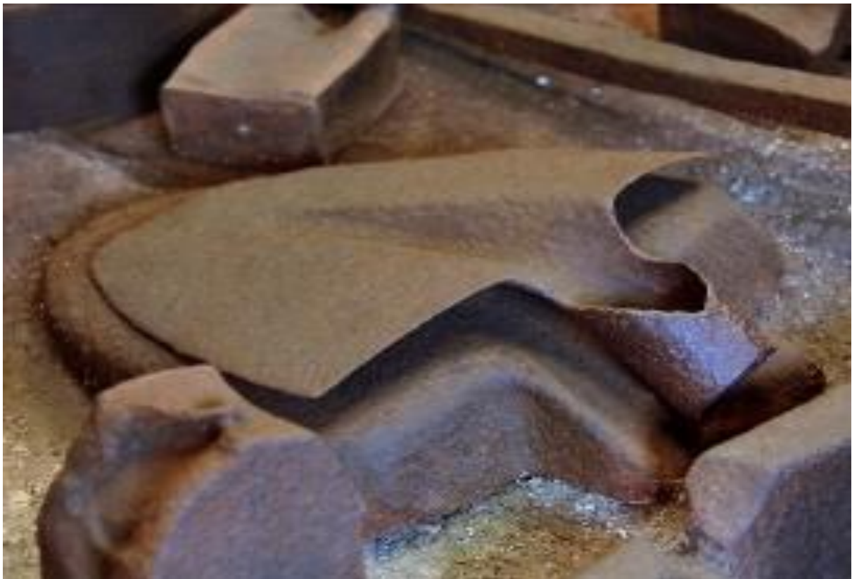
Obr. 40. Lisovanie lopaty z plechu mechanickým lisom cezliatinovú matricu.
