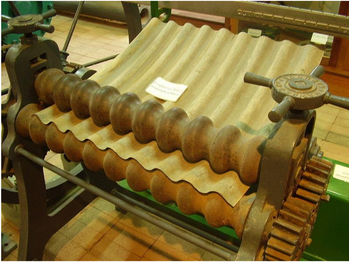
Obr. 118. valcovacia stolica vo Chvatimechu na výrobu vlnovkatého plechu.
