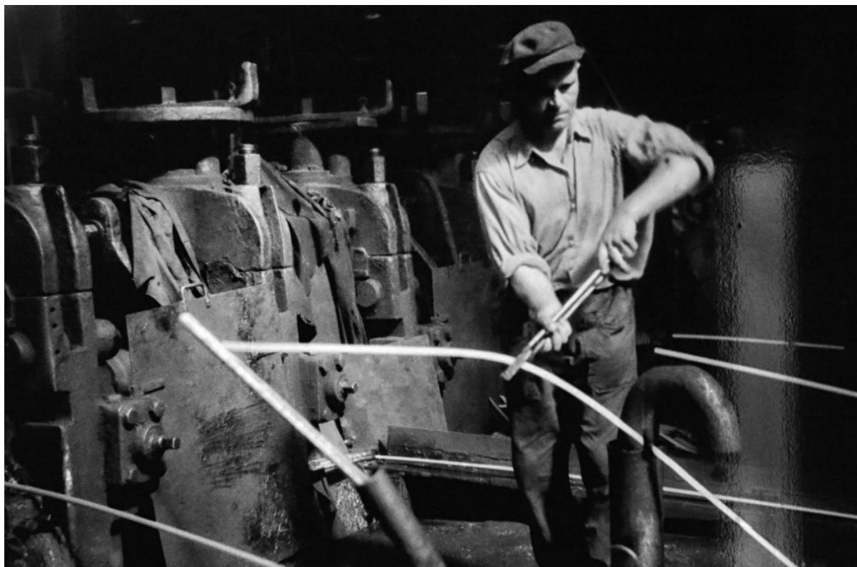
Obr. 117. Valciar pri valcovacej stolici vkladá žeravú valcovanú tyčovinu.
