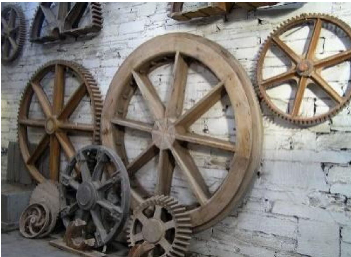
Obr. 13. Drevené modeli remenic a ozubených kolies vyrobených v modelárni.
