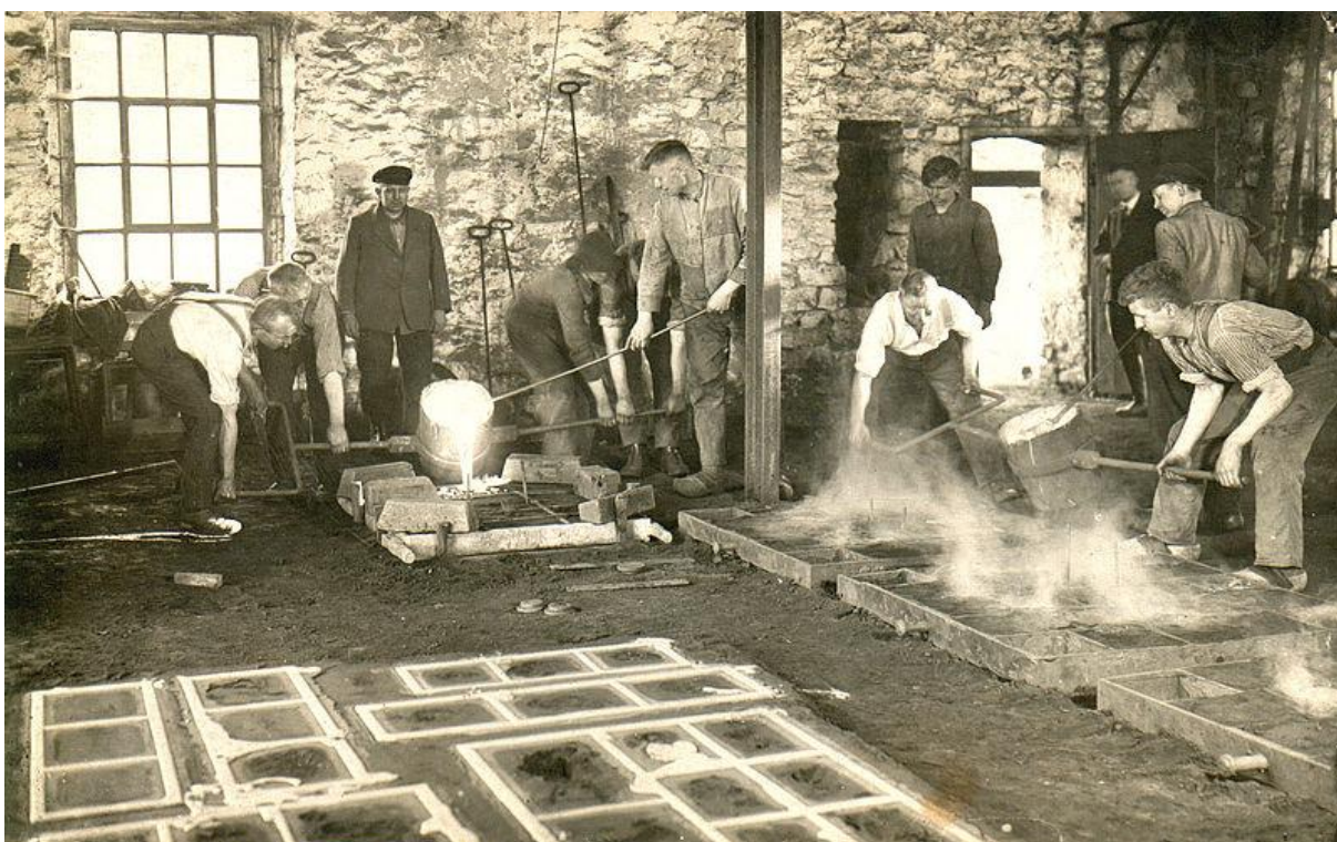
Obr. 14. Odlievanie liatinových okien do piesku a ostatných odliatkov do rámov.
