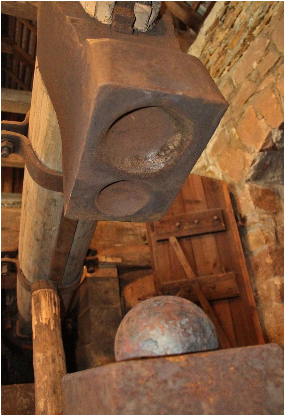
Obr. 5. Upravené kladivo vodného hámra pre konečnú kalibráciu delových gúl.
