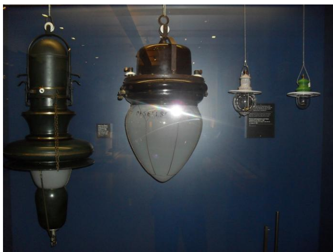
Obr. 97. Osvetlenie v halách zabezpečovali oblúčkové lampy s vysokou svietivosťou spravidla vždy jedna uprostred objektu. V ostatných priestoroch sa používali Edisonove žiarovky.
