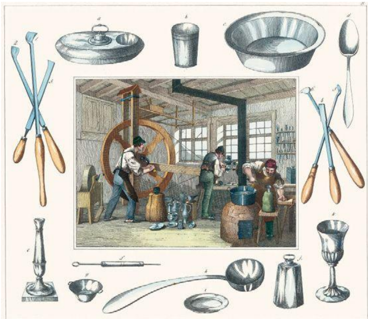
Pôvodné remeslo klmpiarov, náradie a výrobky z plechu. Po zavedení priemyselnej výroby riadu lisovaním ručná výroba zanikla koncom 19. storočia.
