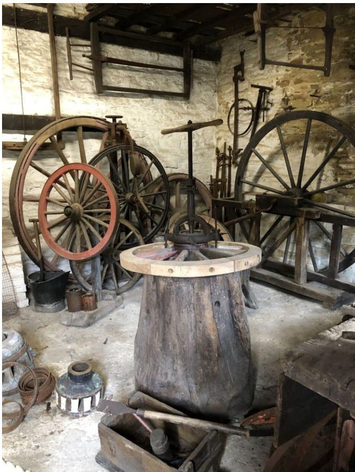
Kolárska dielňa s výrobnými nástrojmi pre zostavovanie prvkov kola.
