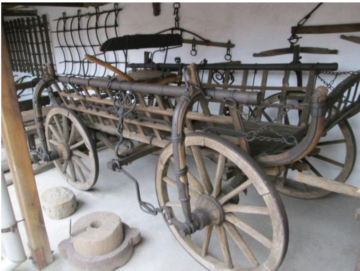
Hotový vóz - rebriňák na porovnanie pomeru dreva a kovu pri jeho výrobe.
